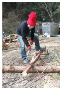
製材機にかける前に余分な皮を剥ぎます
