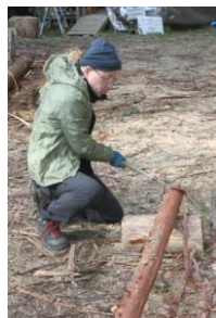
製材機にかける前に余分な皮を剥ぎます
